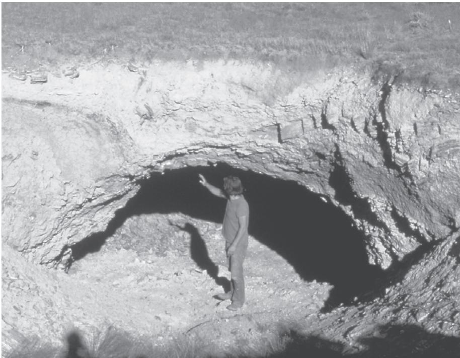
◀ **Figura 5.26.** La subsidencia por desplome de labores en una antigua mina de carbón en Wyoming es una amenaza para la ganadería. (Fotografía de Gary Glass.)
