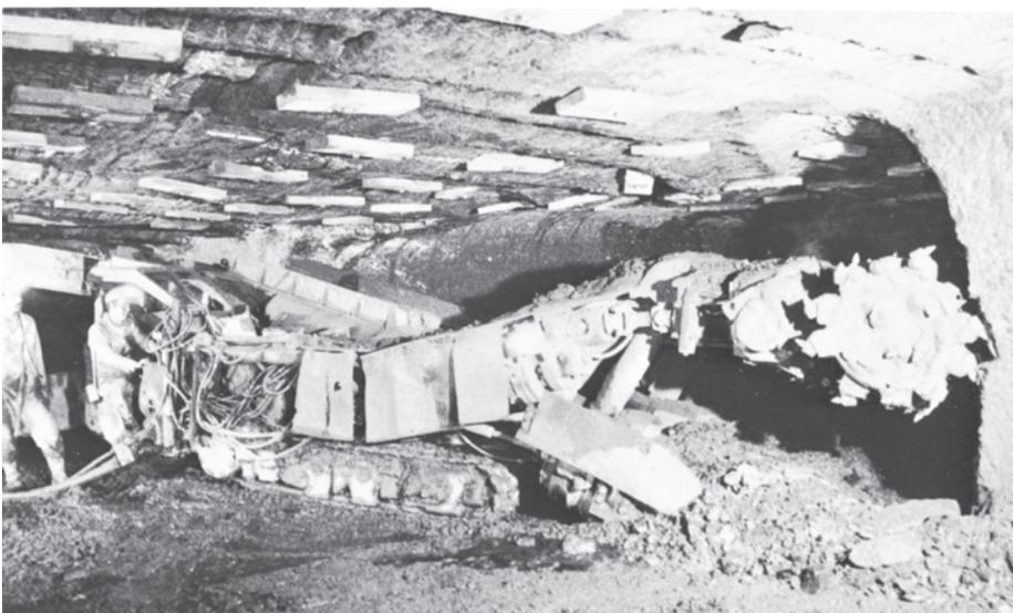
◀ **Figura 5.19.** Minador continuo trabajando. El tambor giratorio del frente corta el carbón y lo vuelca en una cinta transportadora que lo lleva hacia atrás para cargarlo en vagonetas o en otra cinta, que lo saca de la mina. (Fotografía cortesía de A. T. Massey Coal Co., Inc., y Heffner & Cook, Inc.)
