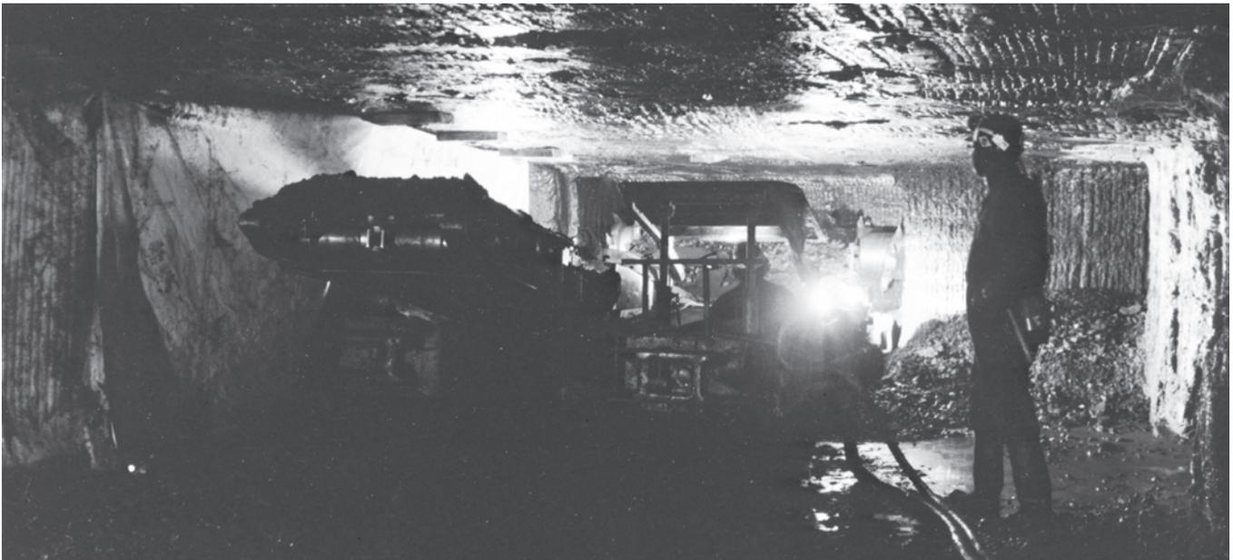
▲ **Figura 5.18.** A menudo se dejan pilares en carbón, a los lados del frente de explotación, para sostener el techo, a medida que avanza el frente. Estos pilares, que pueden contener una gran proporción de carbón, se recuperan normalmente en retroceso, cuando los mineros «se retiran» de una mina porque sus reservas están agotadas. (Fotografía cortesía de la Compañía de Aceros Bethlehem.)
