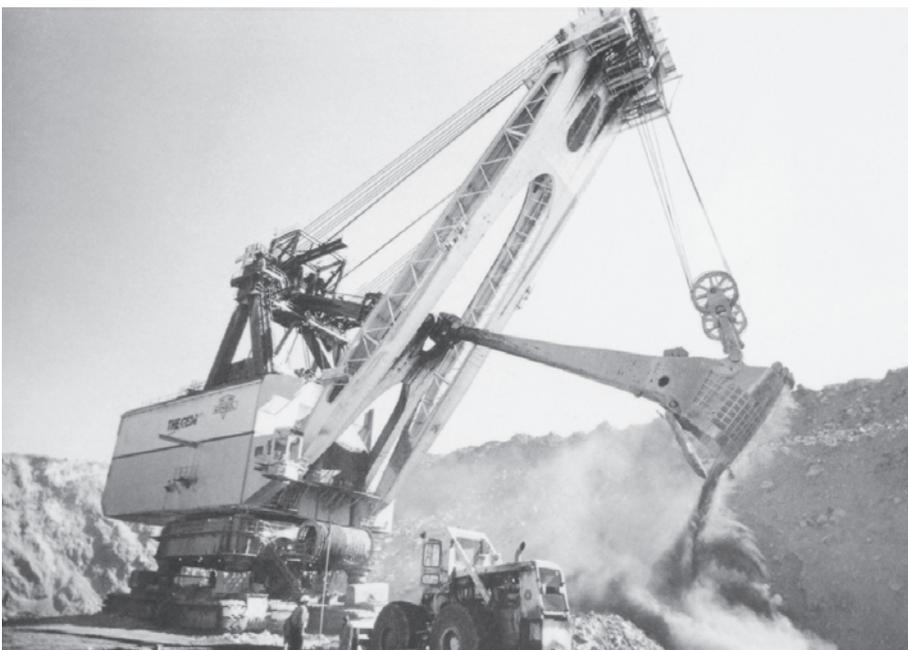
◀ **Figura 5.21.** La «Gema» es la pala de mayor potencia de los Estados Unidos, que se muestra aquí llevando a cabo labores mineras en Ohio. La pala, que tiene una capacidad de cazo de 300 a 500 toneladas, se usa para retirar el recubrimiento y dejar al descubierto las capas de carbón infrayacentes. (Cortesía de la empresa Consolidation Coal.)
